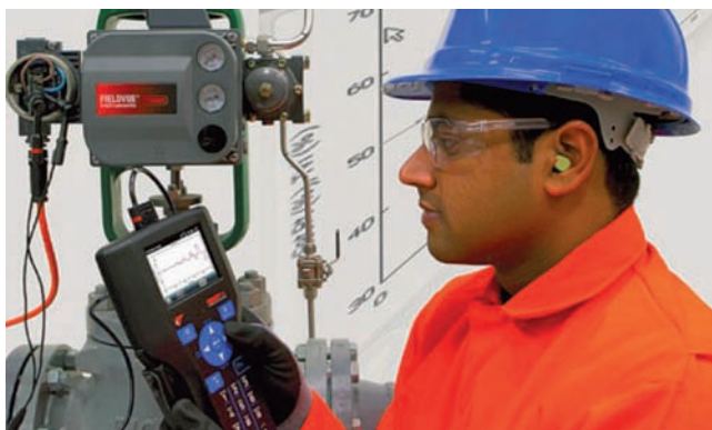
Vďaka softvéru ValveLink™ možno monitorovať dynamický výkon kriticky dôležitých ventilov.
