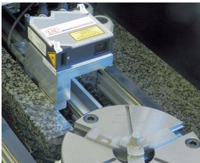
Srdcom nového kalibračného zariadenia je laserový skener Micro-Epsilon.
