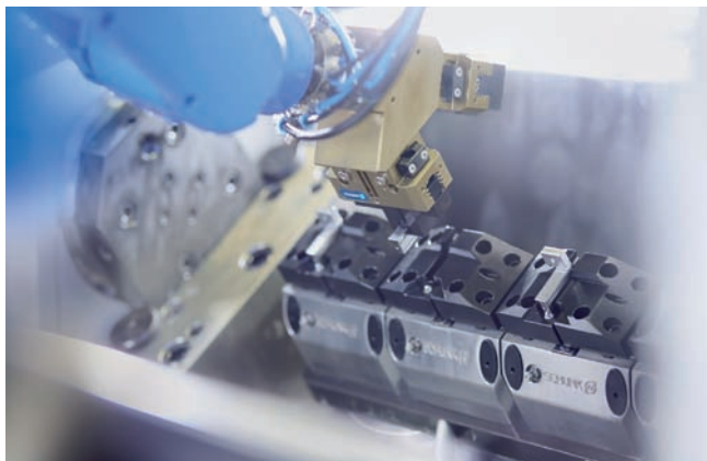
S rýchlovýmenným paletovým systémom SCHUNK VERO-S môže obsluha rýchlo a jednoducho odstrániť zo stroja kompletne upínacie silové bloky SCHUNK TANDEM.
