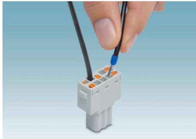
Obr. 3 Jednoduché a rýchle pripojenie vodiča pomocou technológie push-in: vodič ukončený káblovou dutinkou je zatlačený do kontaktnej komory.
